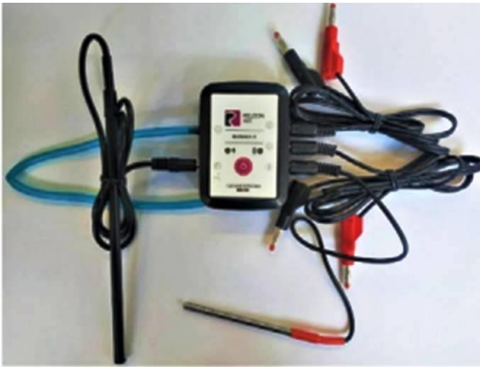
Рис. 2. Беспроводной мультидатчик Releon Air «Физика-5»
