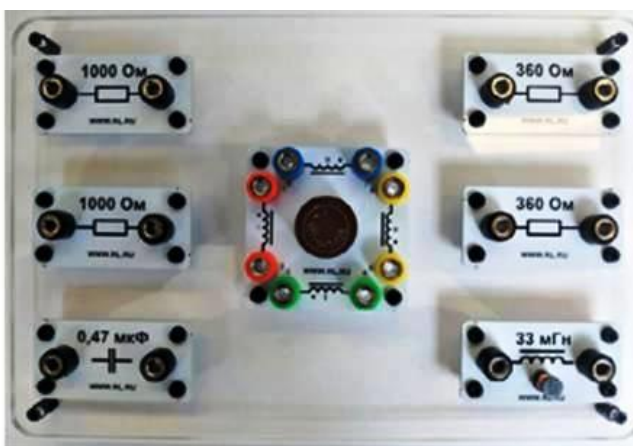
Рис. 10. Дополнительные элементы электрических цепей
